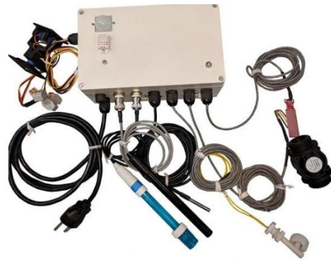
Figura 23. Organización y ubicación de los sensores en el prototipo propuesto.
