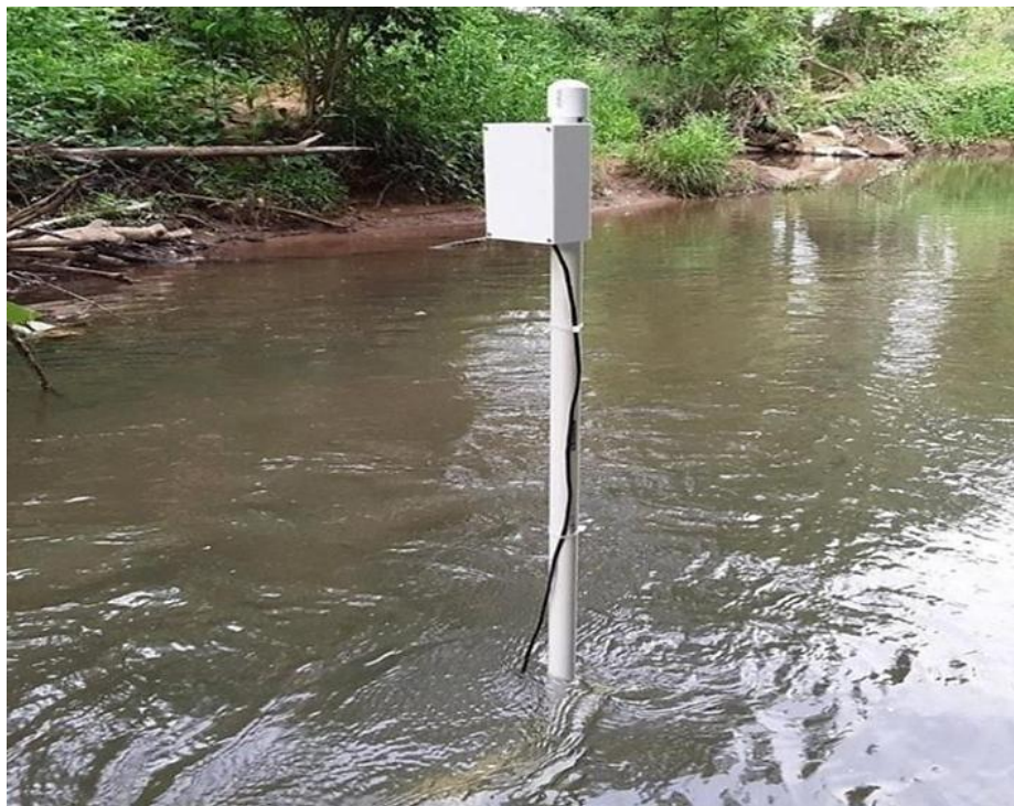
Figura 22. Prototipo propuesto para la captura de parámetros ambientales del cuerpo de agua en estudio.
