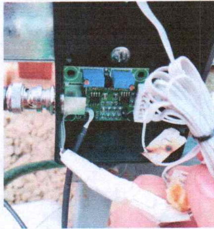
Figura 9. Tarjeta de control sensor de pH fuente: autores del proyecto.
