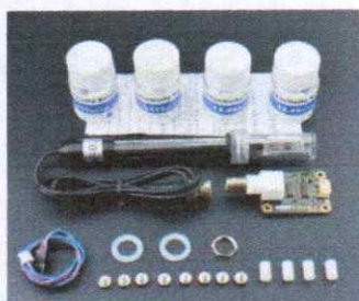
Figura 5. Sensor de conductividad eléctrica analógico para ARDUINO. Fuente: didacticaselectronicas, (2020)
