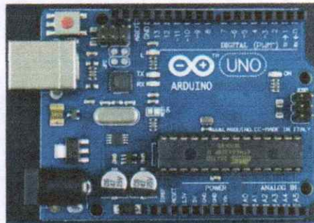
Figura 10. Tarjeta de control Arduino Fuente: vistronica, (2020)
