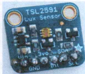
Figura 3. Sensor de luz TSL2591. Fuente: Autores del proyecto.
