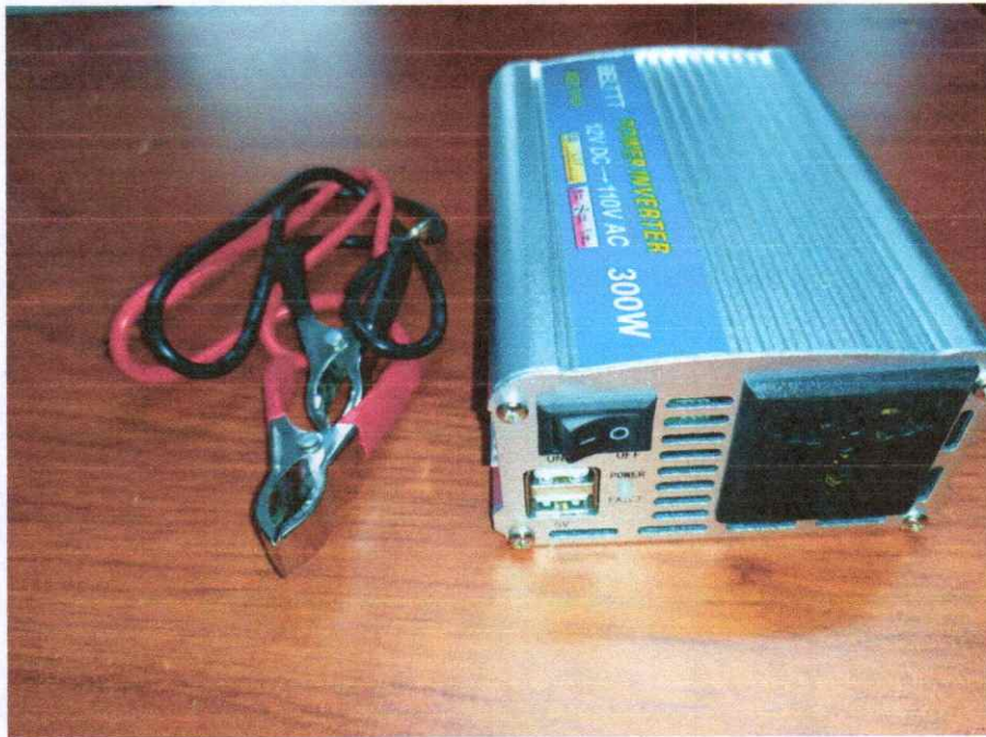
Figura 21. Inversor de tensión DC-AC Fuente: [El Autor]
