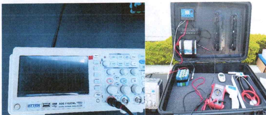
Figura 34. Medición con osciloscopio de VAC a la salida del inversor Fuente: [El Autor]
